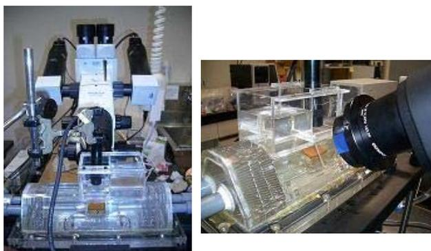
図 2 流体計測チャンバーと実体顕微鏡
